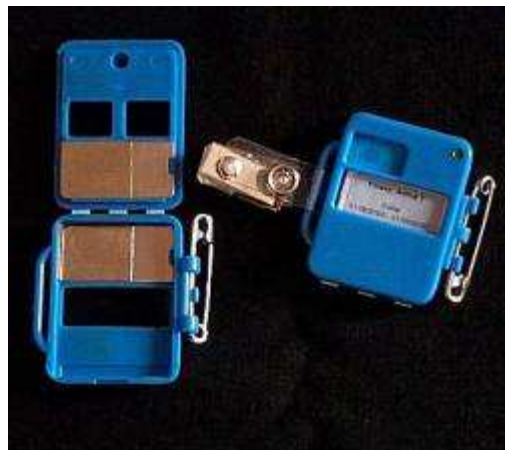
Figura 6: Dosímetro personal de película: aspecto externo y filtros en el interior del portadosímetro
